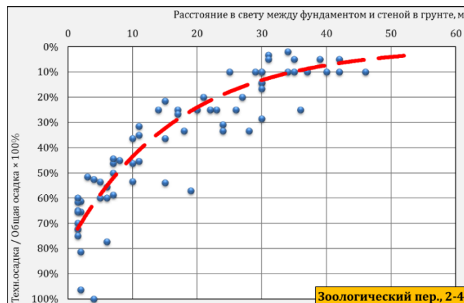
Рисунок 1.10. - Доля технологической осадки в общей итоговой осадке в зависимости от расстояния до «стены в грунте»
