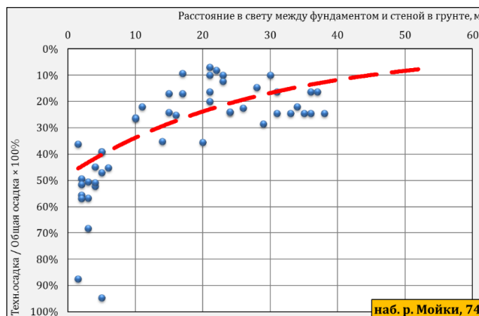
Рисунок 1.11. - Доля технологической осадки в общей итоговой осадке в зависимости от расстояния до «стены в грунте»
